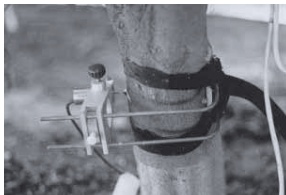
Fig. 18 Un ejemplo de sensor LVDT (Linear Variable Displacement Transducer), en este caso aplicado sobre un melocotonero, capaz de monitorizar las contracciones diarias del diámetro del tronco. Foto IRTA, Barcelona, España
