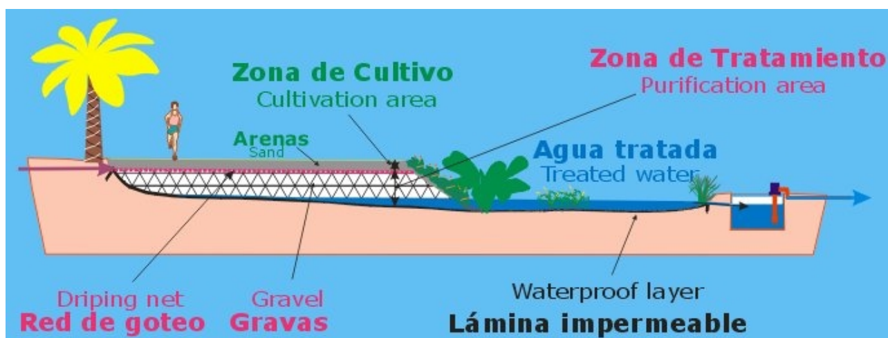
Figura 2.- Esquema de depuración simbiótica®.
