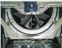
Despalillador formado por dos hélices de paños, para dar un trato delicado a la uva y con opción a paletas de goma.
